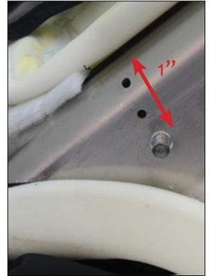
Capacité de repositionnement de l'accessoire 1" vers l'arrière Tiges optionnelles de 1" de plus optionnelles pour monter un dossier plus petit sur un fauteuil plus large
