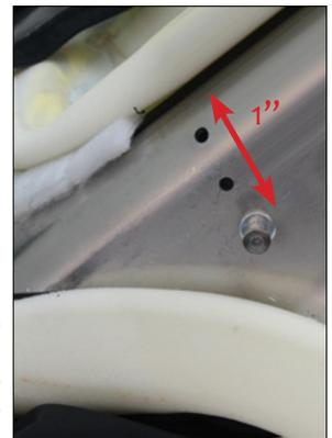
Capacité de repositionnement de l'accessoire 1" vers l'arrière
