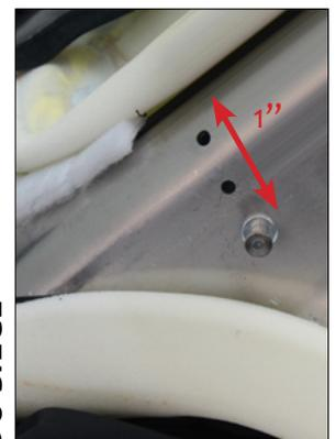
Capacité de repositionnement de l'accessoire 1" vers l'arrière
